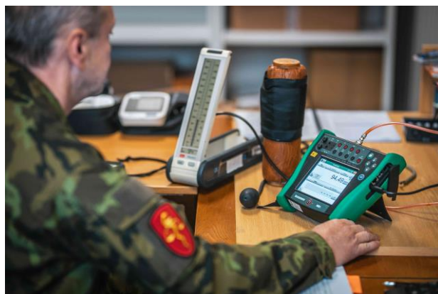
Obr. 8: Kalibrace tonometru pracovníkem akreditovaného metrologického střediska
