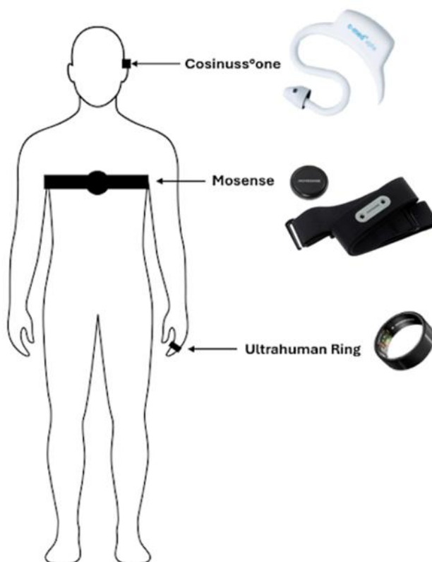
Obr. 1: Testované nositelné systémy a přehled jejich umístění na těle probanda
