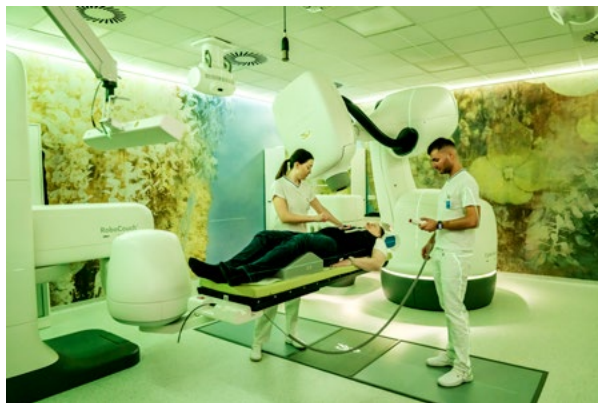
Rozšíření systému CyberKnife umožňující jako jediný radiochirurgický ozařovač ozáření pohyblivých cílů pomocí trackingu ložiska
